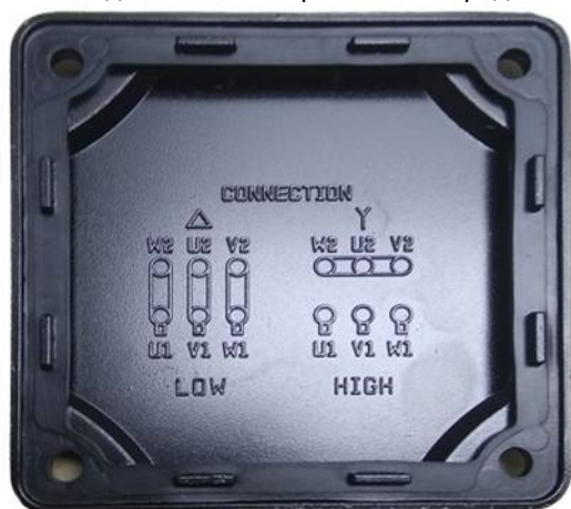
Подключение по схеме «треугольник» (Δ).
